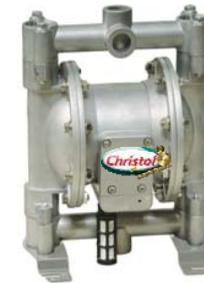
Ideal zum Pumpen von Öl und Altöl - verhindert statische Aufladung. Pumpengehäuse aus Aluminium. Dichtungen aus Viton. Geringe Schmutzempfindlichkeit. Max. Durchfluss 45 l/min, max. Druck 8 Bar Ein-/Auslass 1/2" Lufteinlass 1/4"
