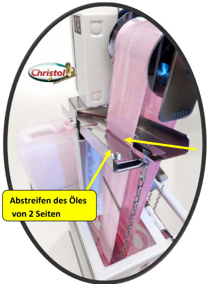
Die LOPO Bandskimmer dienen zur Entfernung von nicht emulgiertem, aufschwimmendem Öl aus Flüssigkeiten, wie z. B. Wasser oder Kühlschmieremulsionen.
